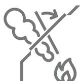
In caso di rilevamento di fumo, la finestra si apre automaticamente per consentire la rapida fuoriuscita del fumo e del calore in eccesso. La finestra è conforme ai requisiti dell'UE. Le finestre per tetti per l'evacuazione di fumo e calore VELUX possono essere aperte anche per lasciar entrare aria fresca con funzione di ventilazione.
